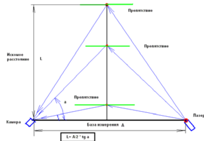
Рис. 75. Метод измерения ИК-дальномером.
